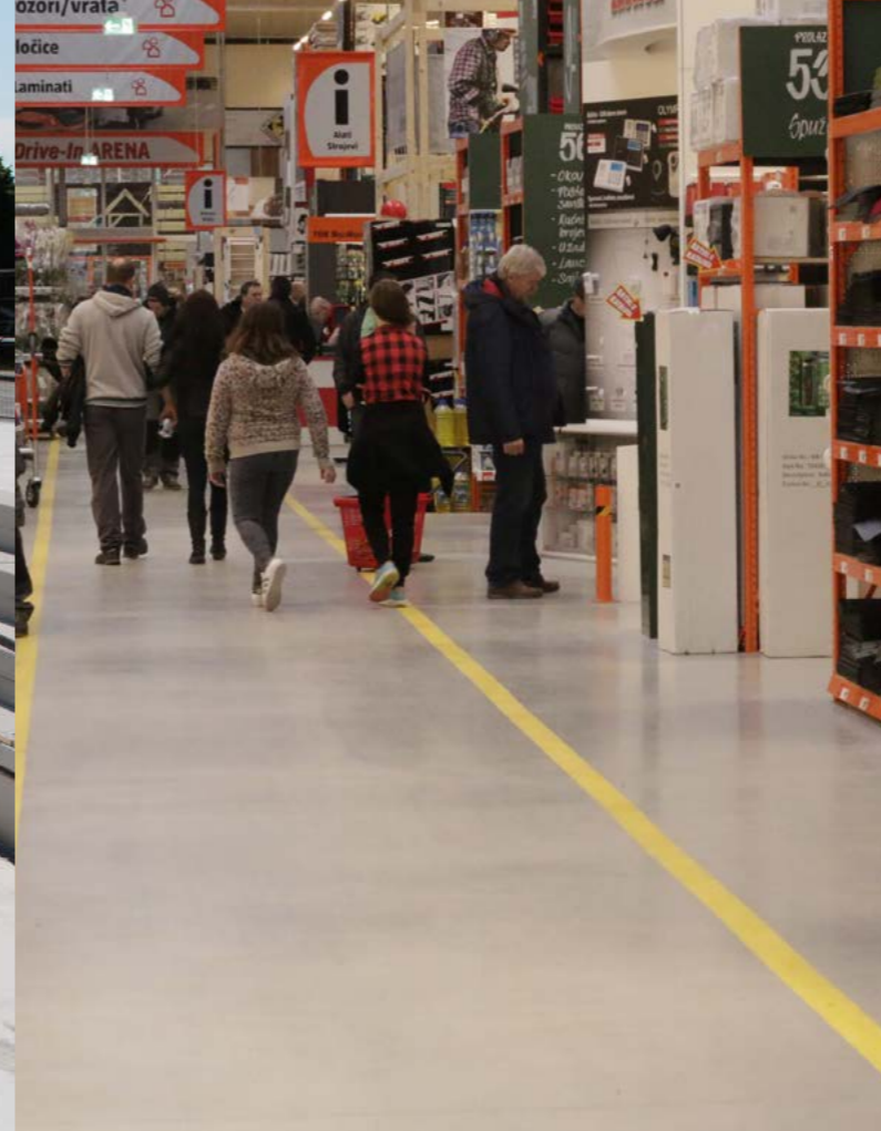
*TC BAUHAUS BUZIN, Zagreb / unutarnja i vanjska podna ploča armirana sa Fibrofor HighGrade 190 / doziranje 1kg/m 3 / 18.000,00 m 2
